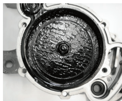
Rys. 3: Szlam olejowy w pompie próżniowej pojazdu VW Transporter wywołuje odgłosy stukania
